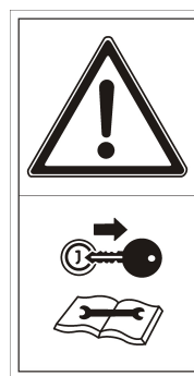
Рис. 4 Все ремонты и настройки - при выключенной машине
