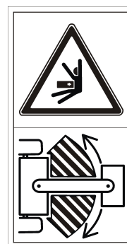
Рис. 8 Запрет пребывания в зоне между трактором и машиной.
