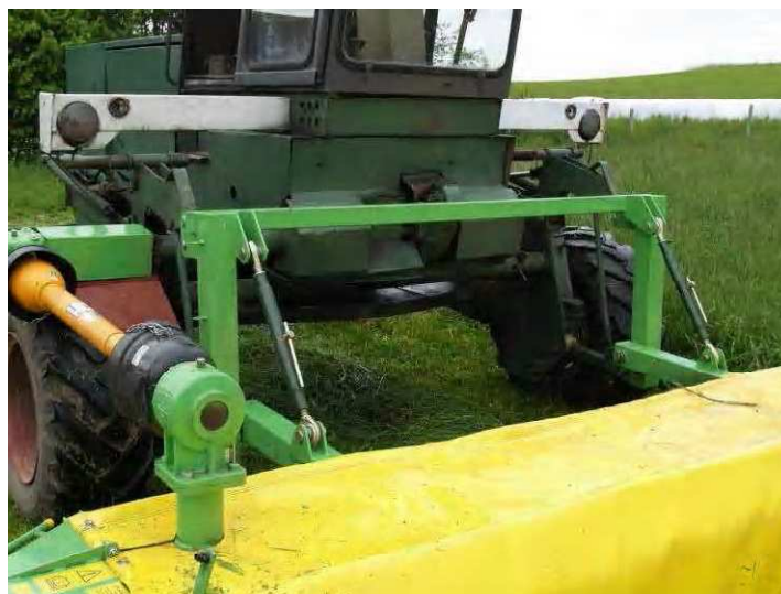
Рис. 4. Самоходная машина «Fortschritt» с косилкой KDF 390.
