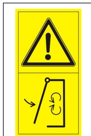
Рис. 5. Предупреждающая пиктограмма Запрещается открывать или снимать крышки при движении вращающихся элементов.
