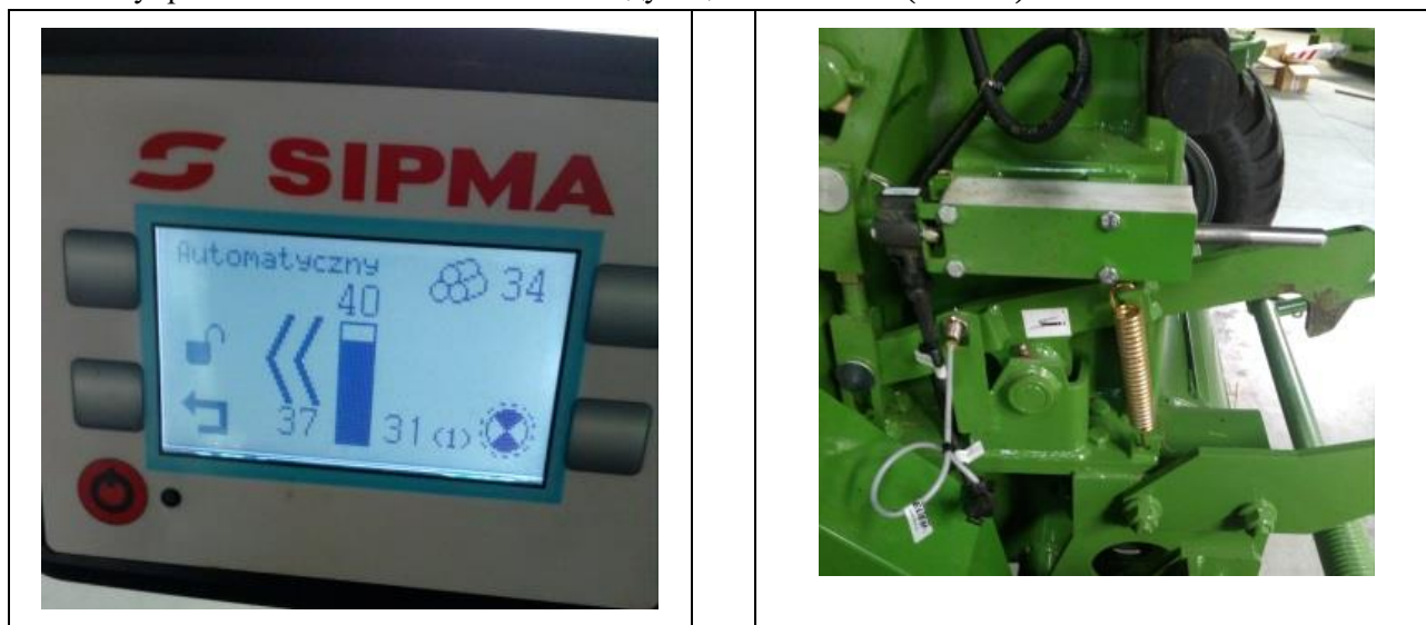
Рис. 55. Компоненты системы управления, вид экрана работы и вид датчика равномерности заполнения
