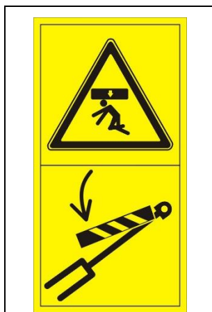
Рис. 8. Предупреждающая пиктограмма Опасность раздавливания тела. Необходимо заблокировать поднятую заднюю раму с помощью замка на гидравлическом цилиндре.
