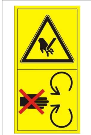
Рис. 12. Предупреждающая пиктограмма Опасность получения порезов или обрезки пальцев или ладоней. Запрещается вкладывать руки в зону механизма обмотки рулонов сеткой при включенном двигателе трактора и включенном приводном валу.
