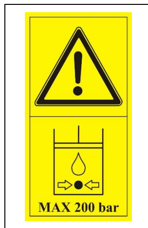
Рис. 3. Предупреждающая пиктограмма Максимальное давление в гидравлической системе составляет 200 бар.
