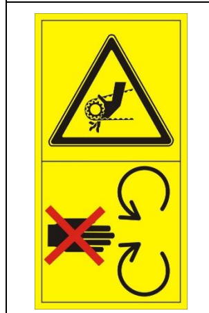
Рис. 13. Предупреждающая пиктограмма Опасность защемления пальцев или кистей рук приводными цепями! Запрещается вкладывать руки в зону цепи, открывать и снимать защитные приспособления при работающем двигателе трактора и приводном валу
