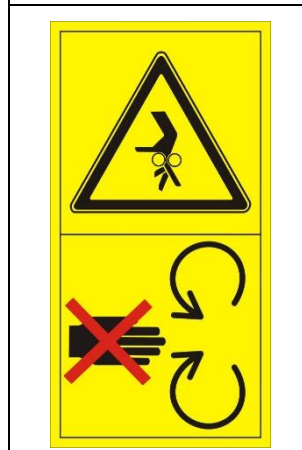
Рис. 11. Предупреждающая пиктограмма Опасность защемления пальцев или кистей рук вращающимися роликами. Запрещается вкладывать руки в зону при включенном двигателе трактора и приводном валу.
