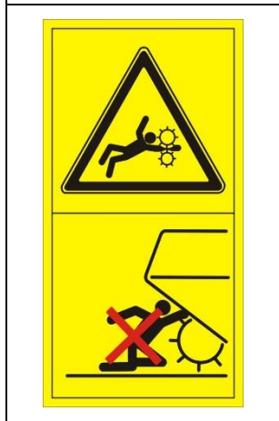
Рис. 6. Предупреждающая пиктограмма Опасность вытягивания рук и/или ног подборщиком. Запрещается вкладывать руки в зону над подборщиком при включенном двигателе трактора и включенном приводном валу.
