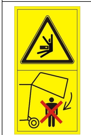
Рис. 10. Предупреждающая пиктограмма Опасность придавливания опускающейся задней рамой Запрещается входить под поднятую заднюю раму при работающем двигателе трактора и до ее блокировки.
