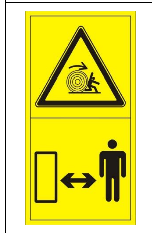
Рис. 7. Предупреждающая пиктограмма Опасность придавливания скатывающимся рулоном! Соблюдайте безопасное расстояние от работающей машины.
