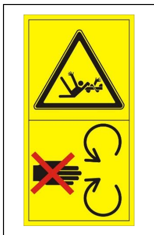
Рис. 2. Предупреждающая пиктограмма Опасность вытягивания рук или верхней части шнековым подавателем. Запрещается вкладывать руки в зону подавателя при включенном двигателе трактора и приводном валу.
