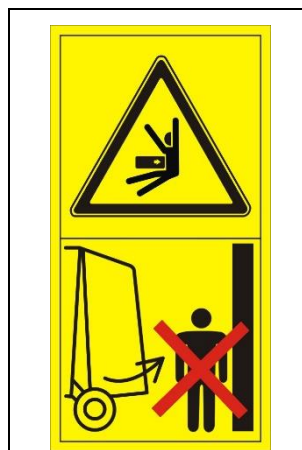
Рис. 9. Предупреждающая пиктограмма Опасность придавливания открывающейся задней рамой. Запрещается пребывать в зоне открывания задней рамы при работающем двигателе трактора.
